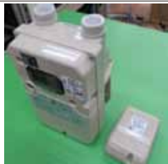
LPガスメーター、自動通報装置
