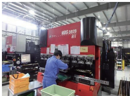
金属板の曲げ加工機
