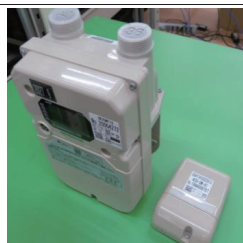
LP ガスメーター、自動通報装置
